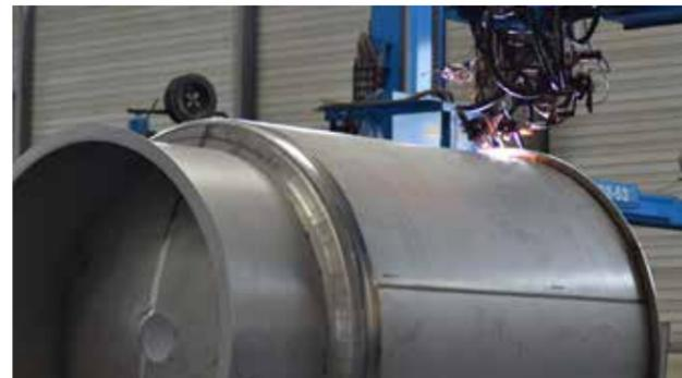
Le procédé de soudage automatique est utilisé pour les soudures longitudinales et circulaires.
