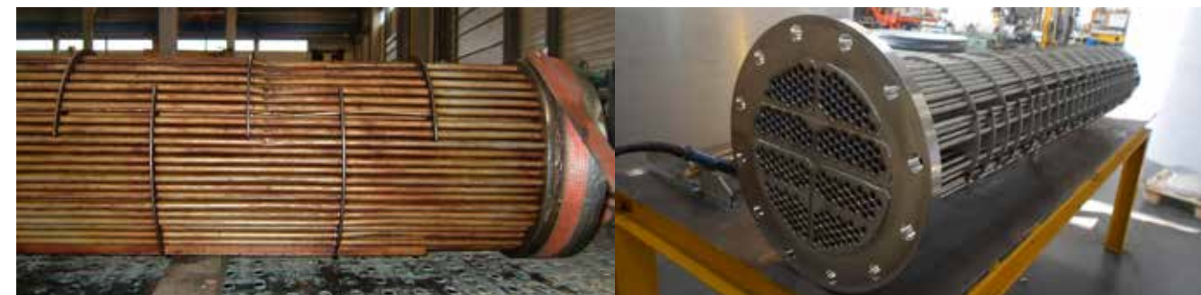
Retubage d'échangeurs tubulaires, de condenseurs et d'évaporateurs
