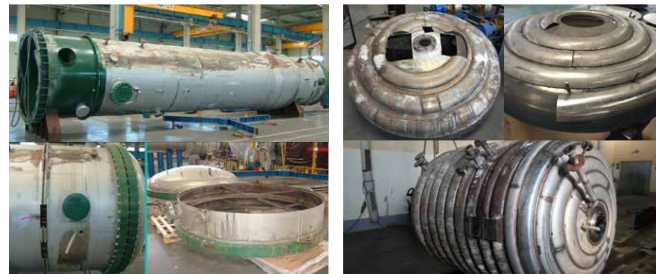
Remplacement de parties d'échangeurs de chaleur
